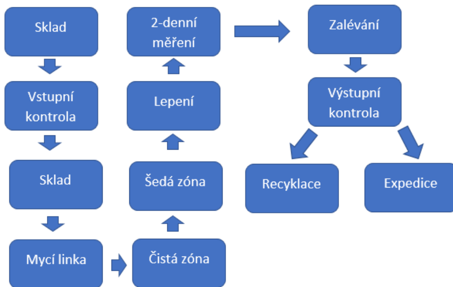
Obr. 3.3 Popis výrobního procesu rentgenových zesilovačů
