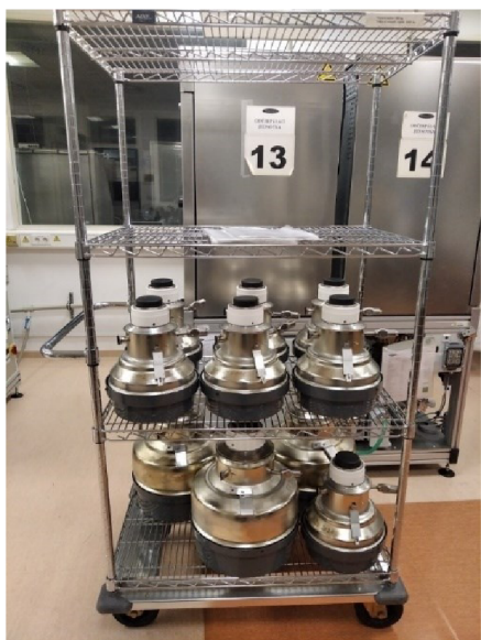
Obr. 4.7 Manipulační vozík pro rentgenové zesilovače
