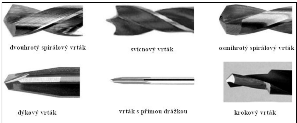
Obr. 2 Různé geometrie vrtáků při vrtání do kompozitních materiálů [4]
