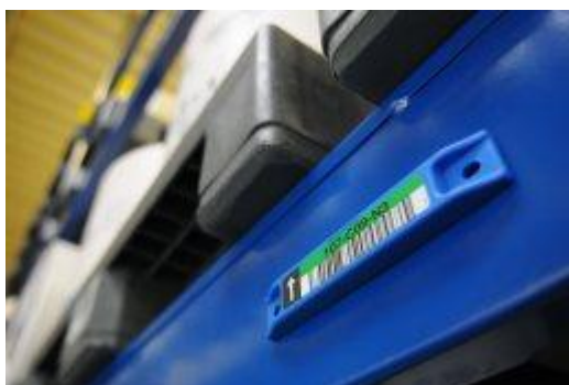
Obrázek 24 - Tagy Inotec vhodné pro umístění na kovovém předmětu (Zdroj: http://www.inotec-barcode.cz )
