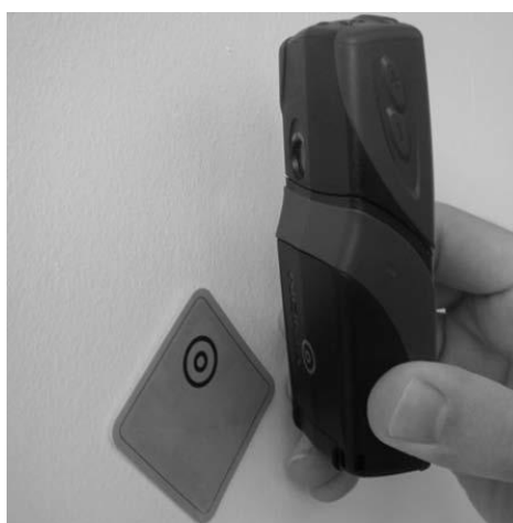
Obrázek 12 - Mobilní telefon komunikující s NFC štítkem [8]
