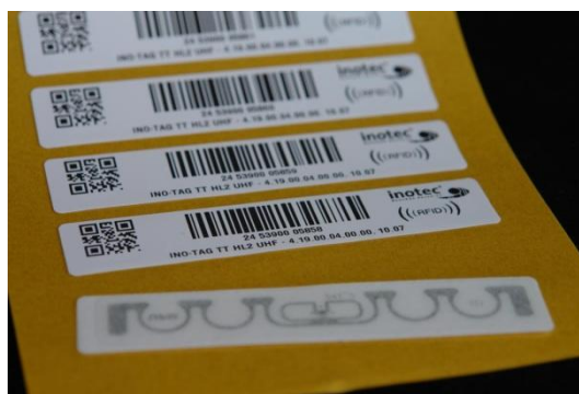
Obrázek 22 - Tagy Inotec ve formě nalepovacích etiket (Zdroj: http://www.inotec-barcode.cz )
