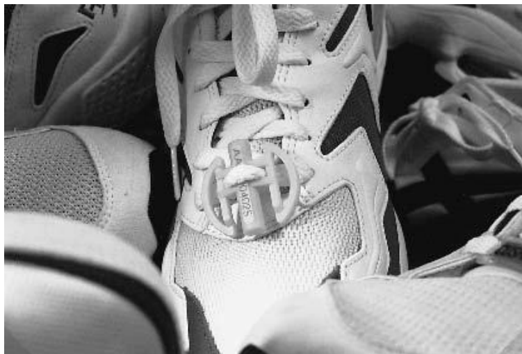
Obrázek 16 - RFID transpondér umístěný na botě běžce [2]
