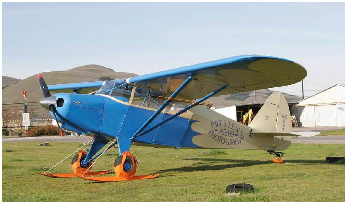
Obr. 6 - Lyže připevňená na pneumatiku podvozku [6]
