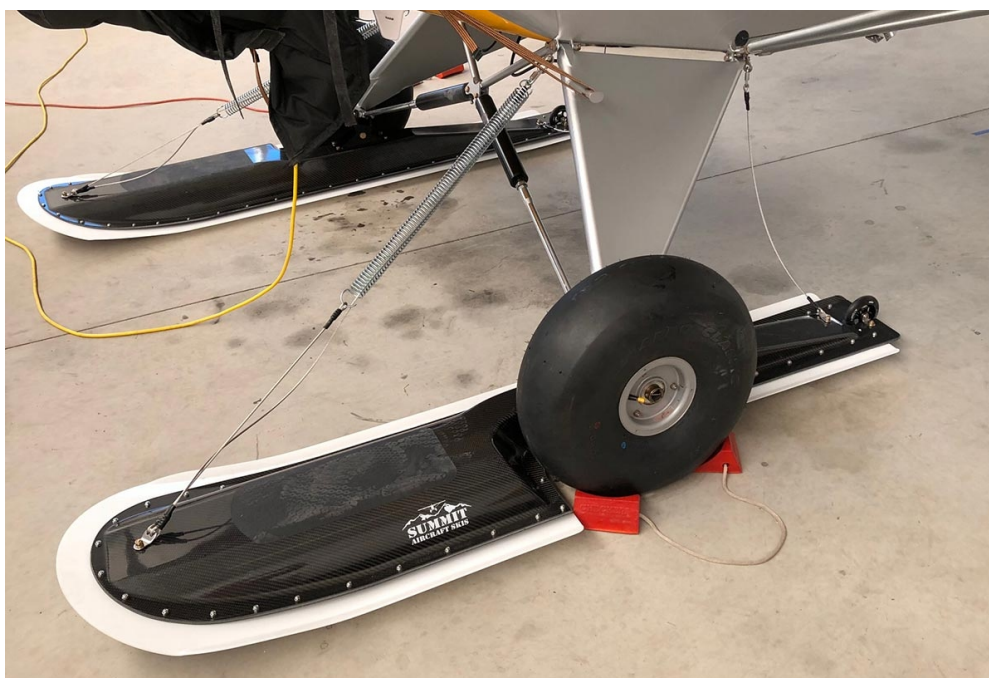
Obr. 9 – Lyže s pneumatikou podvozku vyčnívající pod skluznici [28]
