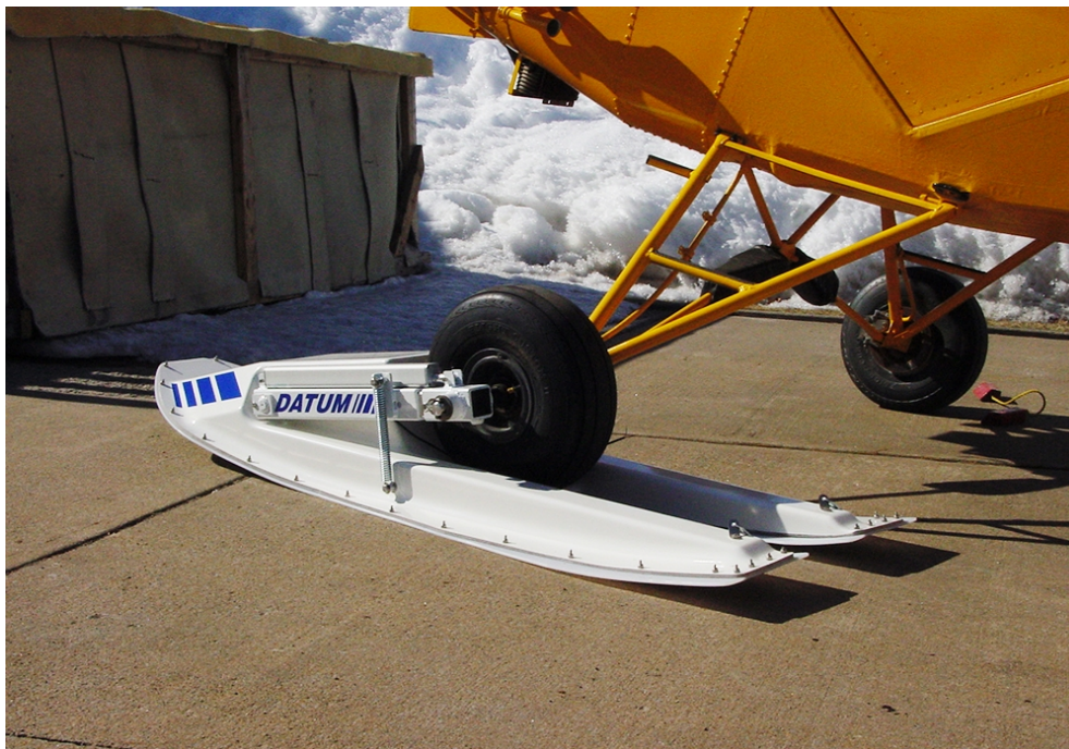
Obr. 8 - Elektricky ovládaná výsuvná lyže společnosti Datum [9]
