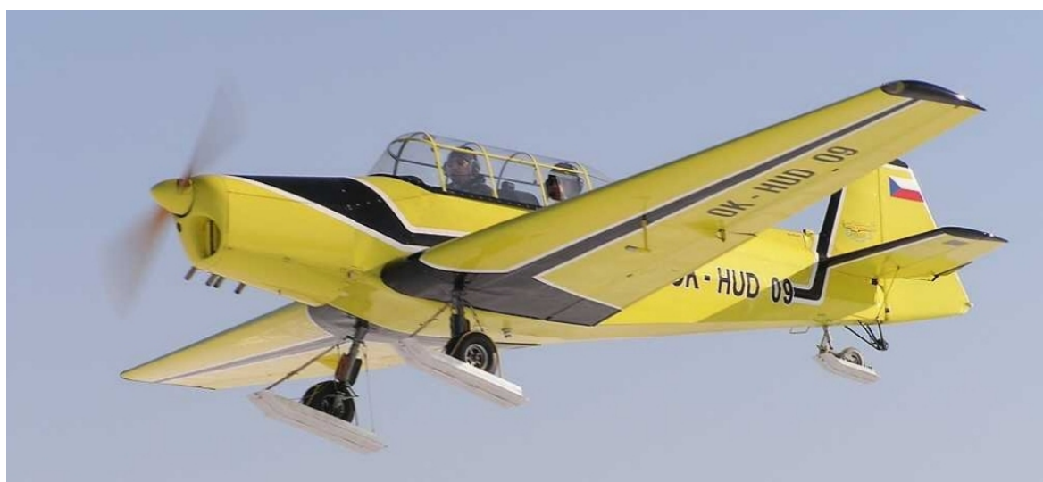
Obr. 7 - Letoun Trener Baby vybavený podvozkiem s lyžemi na pneumatikách [29]
