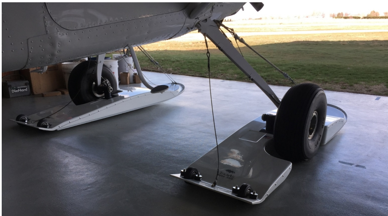
Obr. 11- přídavná kolečka na lyži Alpine 3000 výrobce TrickAir [7]
