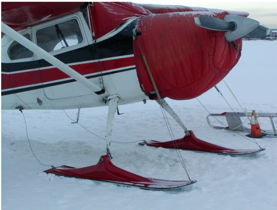
Obr. 5 – Lyže značky Airglas nahrazující kola podvozku [5]
