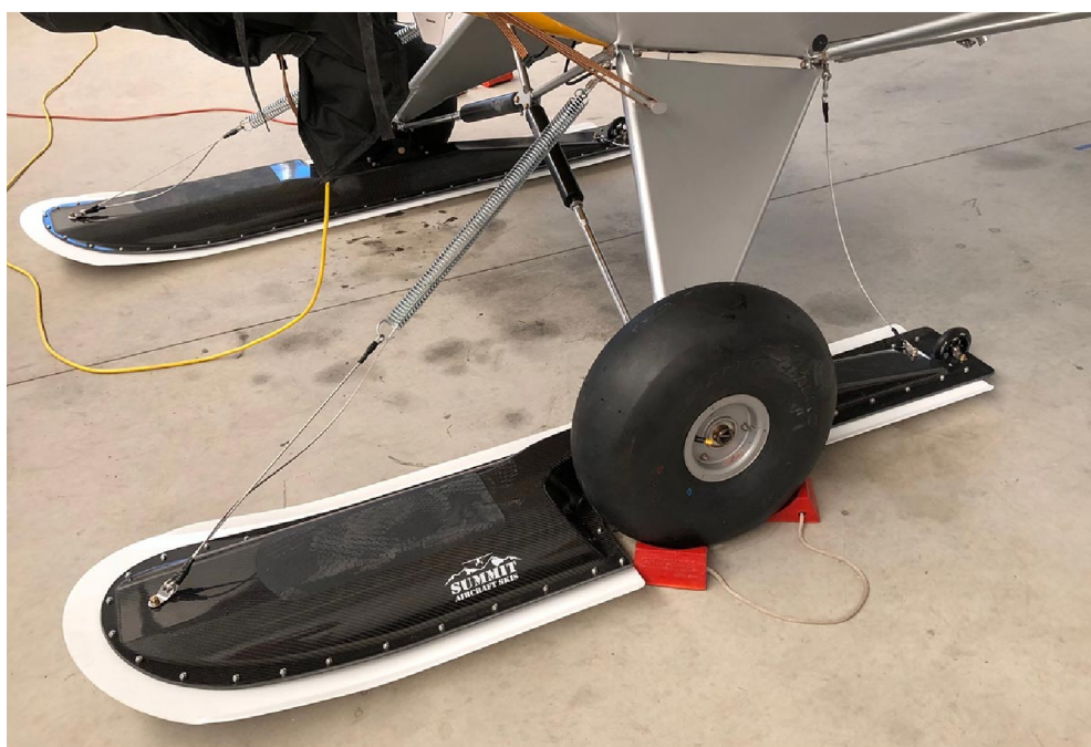
Obr. 9 – Lyže s pneumatikou podvozku vyčnívající pod skluznici [28]
