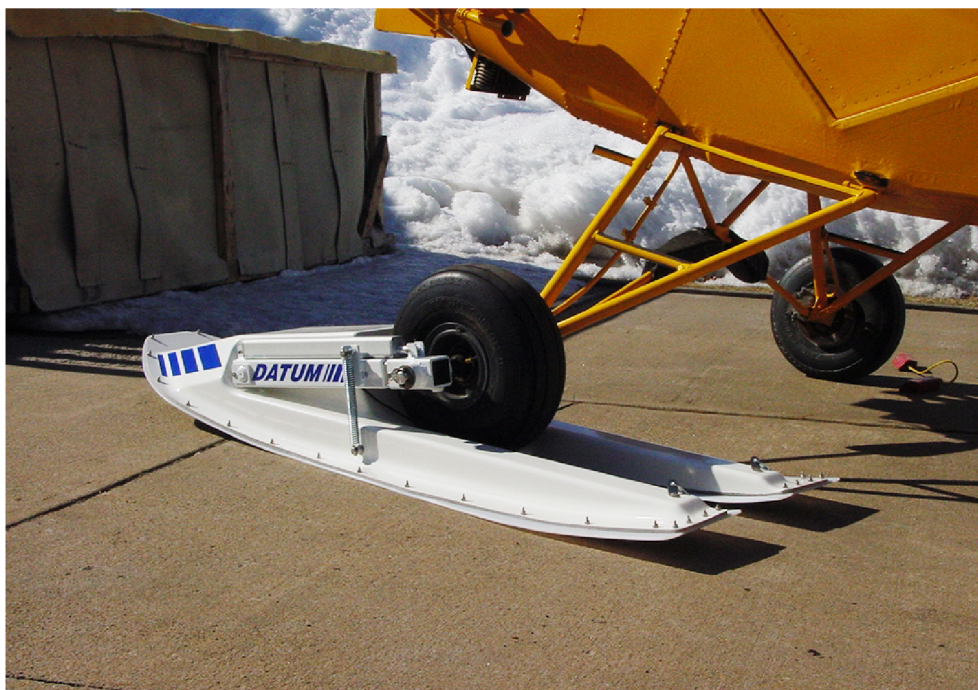
Obr. 8 - Elektricky ovládaná výsuvná lyže společnosti Datum [9]
