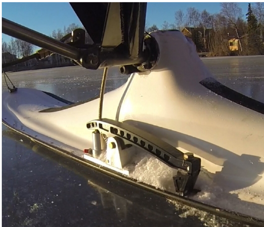
Obr. 12 - Přídavný brzdový systém [3]
