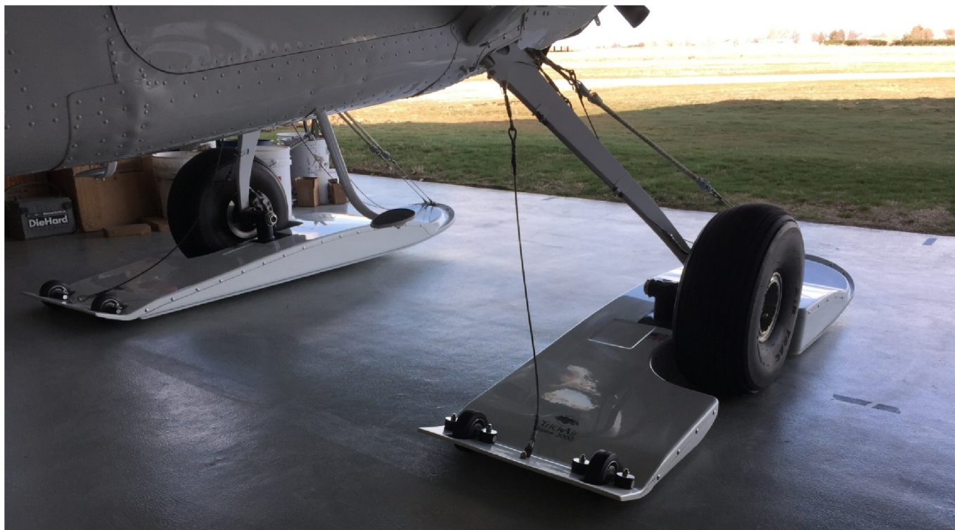
Obr. 11- přídavná kolečka na lyži Alpine 3000 výrobce TrickAir [7]
