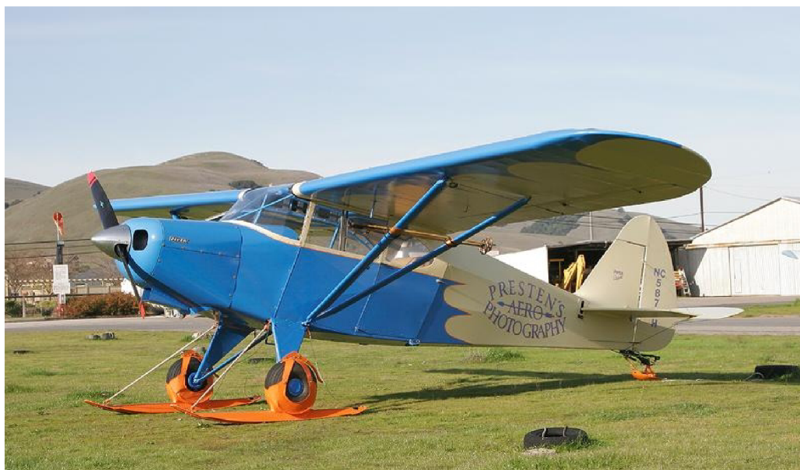
Obr. 6 - Lyže připevněná na pneumatiku podvozku [6]
