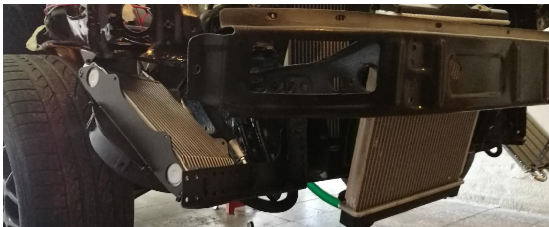
Obr. 39 Zástavba přídavných olejových chladičů a přídavného vodního chladiče.
