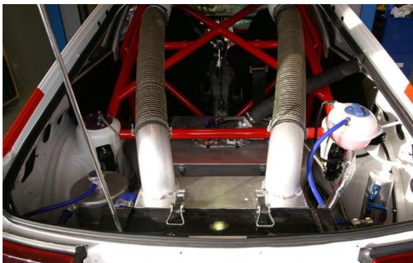
Obr. 23 Umístění chladiče v místech zadní nápravnice [12]
