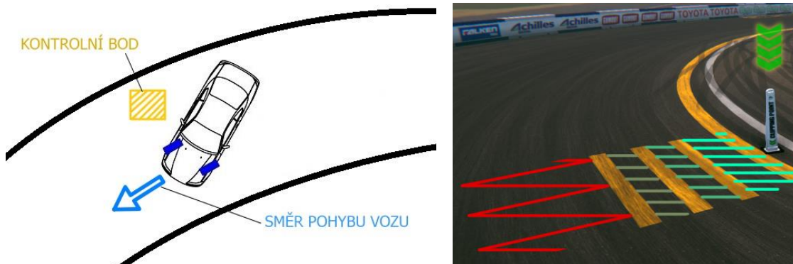
Obr. 2 Přejezdový a přibližovací kontrolní bod [3]
