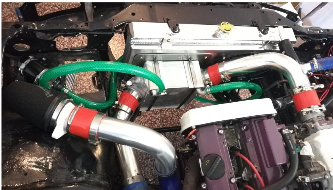
Obr. 38 Ukázka zástavby výměníku Voda-Vzduch
