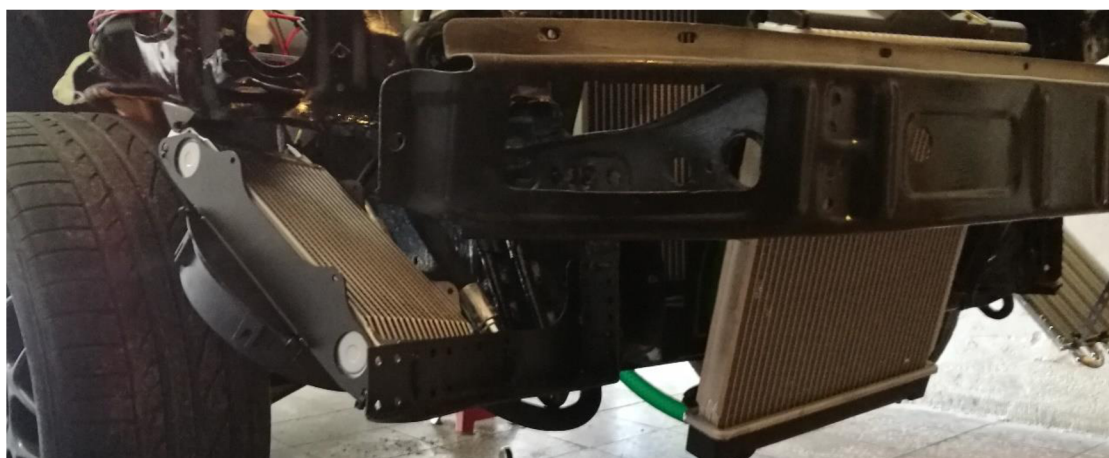
Obr. 39 Zástavba přidavných olejových chladičů a přidavného vodního chladiče.
