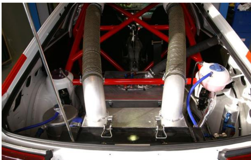
Obr. 23 Umístění chladiče v místech zadní nápravnice [12]
