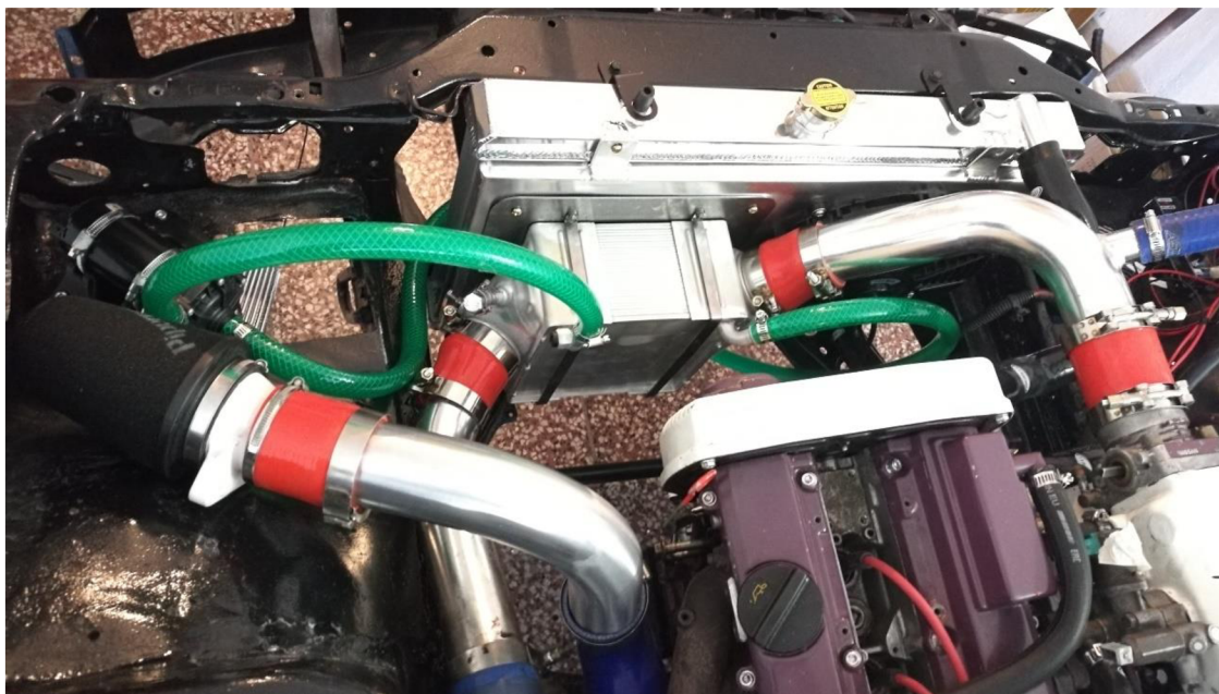
Obr. 38 Ukázka zástavby výměníku Voda-Vzduch
