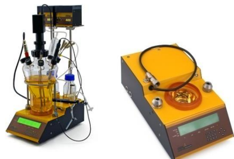
Obr. 11: Zařízení pro pomnožování kvasnic s možností aerace a se zásobním tankem na sterilní mladinu, firemní materiály Essau-Hueber (zdroj: Basařová, 2010)
