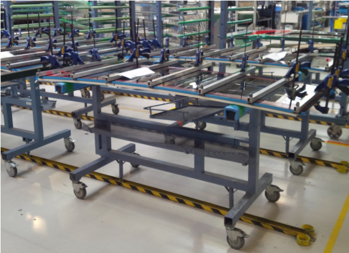
Obr. 3.3: Dveřní křídlo stáhnuté svorkami
