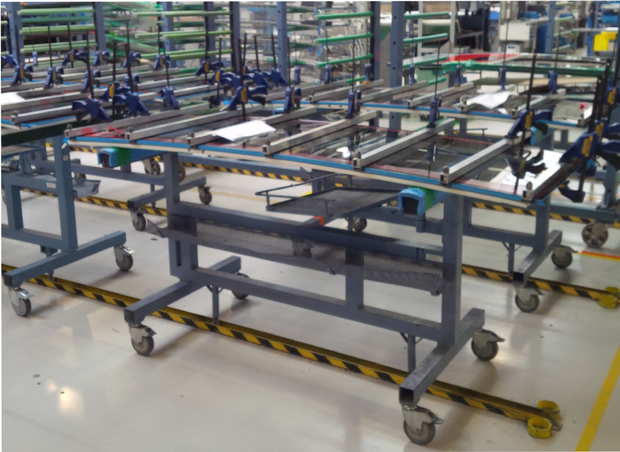
Obr. 3.3: Dveřní křídlo stáhnuté svorkami
