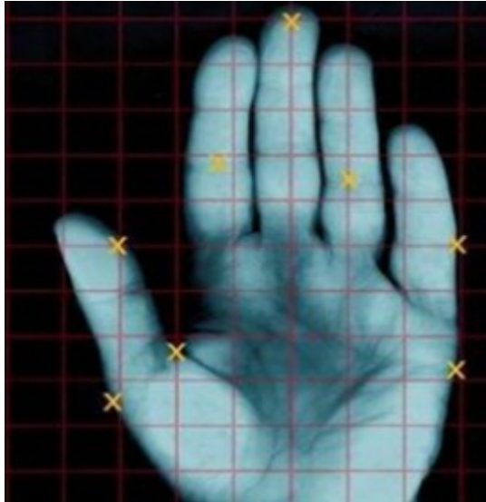
Obr. 5 Snímek geometrie ruky s vyznačenými významnými body (All In One Computing And Electronics, 2016).
