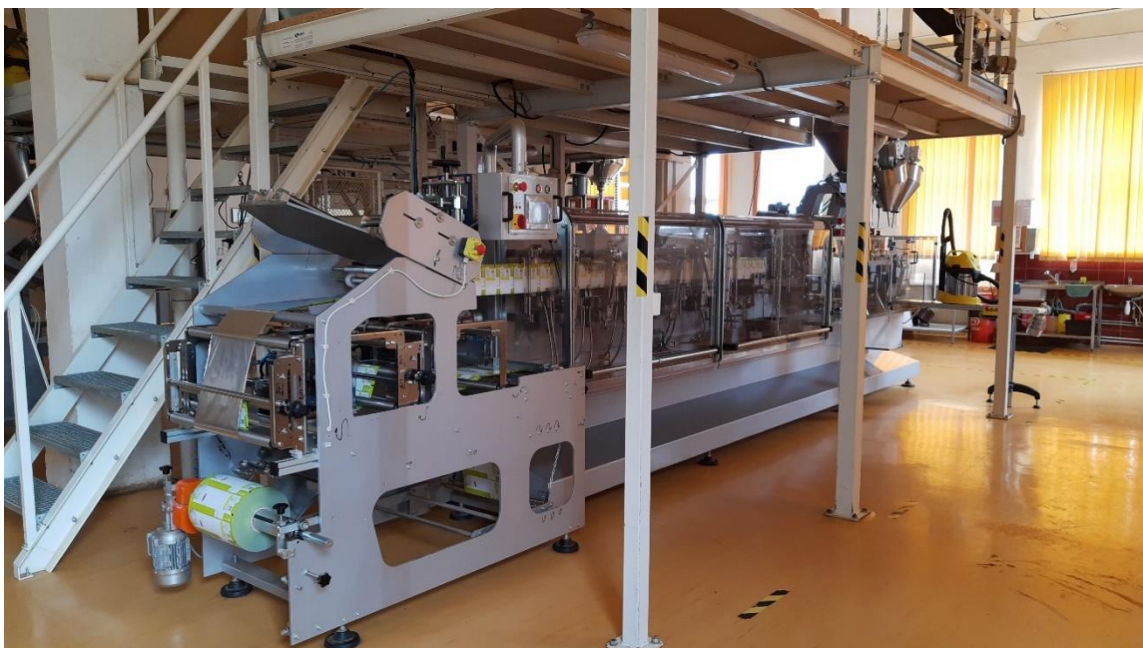
Obrázek 22: Balicí linka zpracovávající koření
