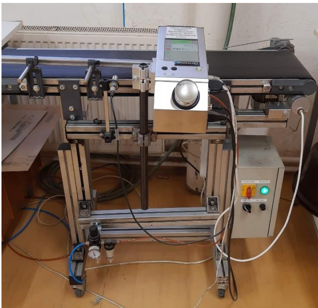
Obrázek 17: Laserová tiskárna – tisk na krabice
