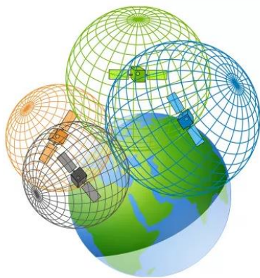
Obrázek 17, Sféry šíření signálu satelitu [35]
