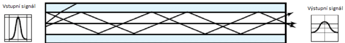
Obrázek 8 - Mnohovidové vlákno se skokovým indexem lomu (9)
