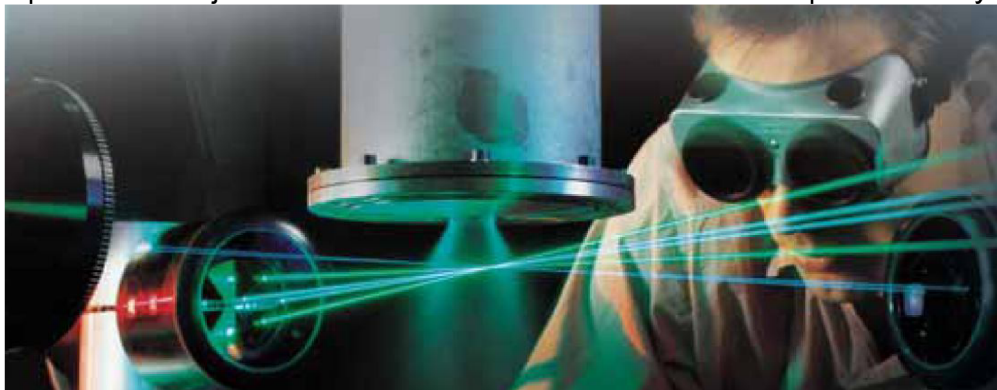
Obr. 3.4- 1 Měření velikosti částic a jejich rychlosti pomocí systému PDA (DLR, Institut techniky pohonu, Kolýn, Německo) [11]
