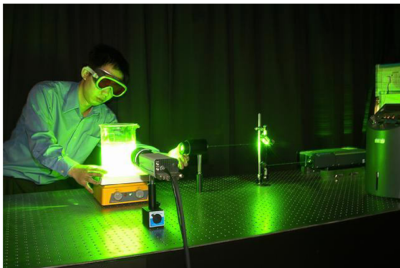
Obr. 4.1- 1 Experimentální PIV systém na Univerzitě vědy a technologií v Hong Kongu [18]
