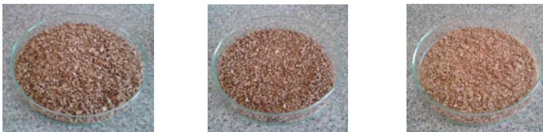
Obr. 14: Jednotlivé stupně dezintegrace mláta. (Zleva: surové, I. stupeň dezintegrace, II. stupeň dezintegrace)
