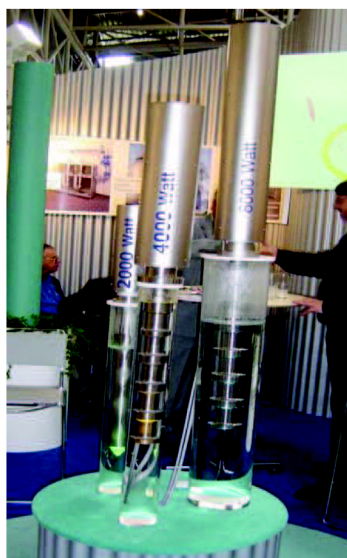
Obr. 6: Sonotródy pro dezintegraci ultrazvukem [26]
