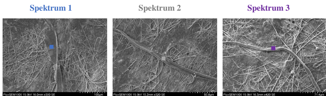
Obrázek 37- Vlákna mikroplastů se spektry
