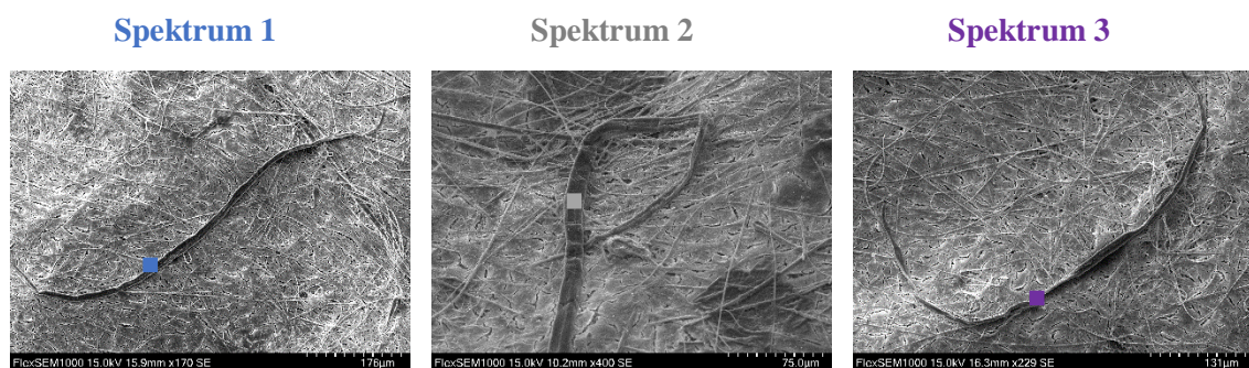
Obrázek 38- Vlákna mikroplastů se spektry
