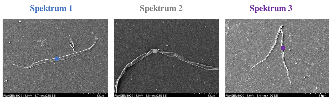
Obrázek 41- Vlákna mikroplastů se spektry
