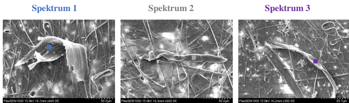
Obrázek 36- Vlákna mikroplastů se spektry
