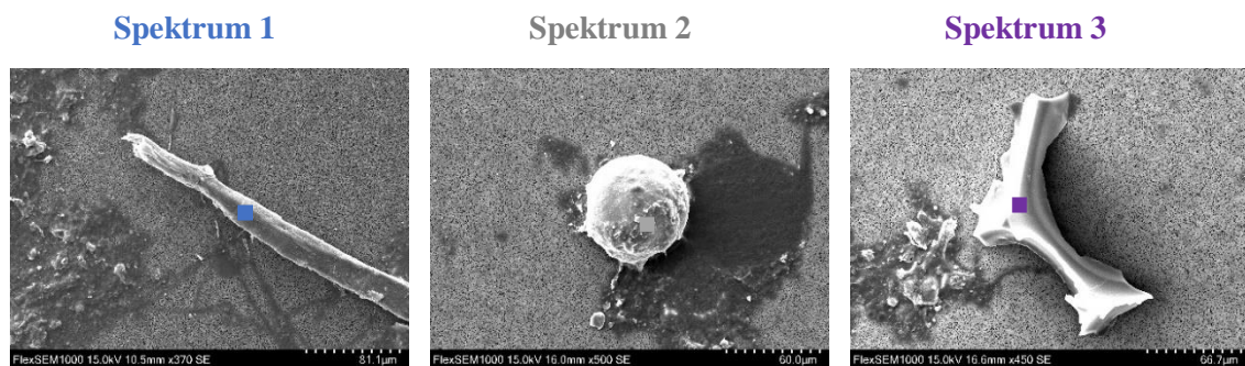
Obrázek 39- Částice mikroplastů se spektry
