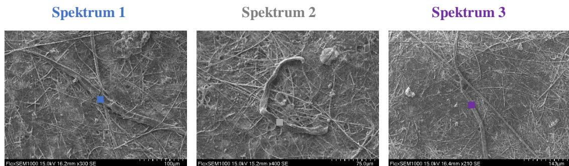
Obrázek 35- Vlákna mikroplastů se spektry
