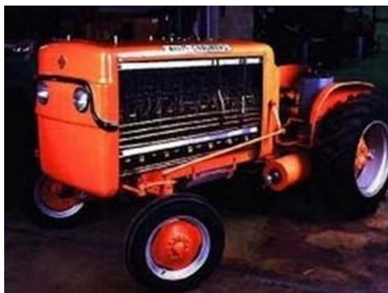
Obr. 5 Traktor poháněný palivovými články od H. K. Ihrida [7]
