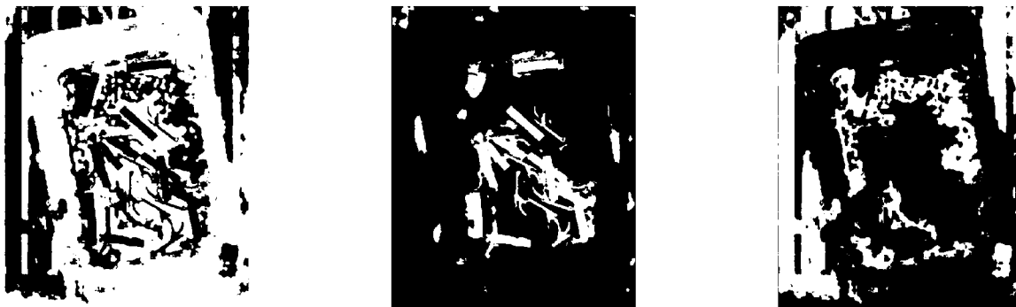
Obrázek 7.5: Vizualizace výstupu ze segmentační sítě vyhodnocené na reálné scéně. První obrázek znázorňuje kategorii None, druhý kategorii Opener a třetí Metal. Na třetím obrázku lze vidět chybně odhadnutou kategorii, kvůli velkému množství šumu a neznámé podložce.
