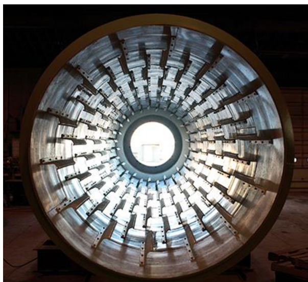
Obr. 2 Vnitřní lopatková vestavba rotačního válce [5]
