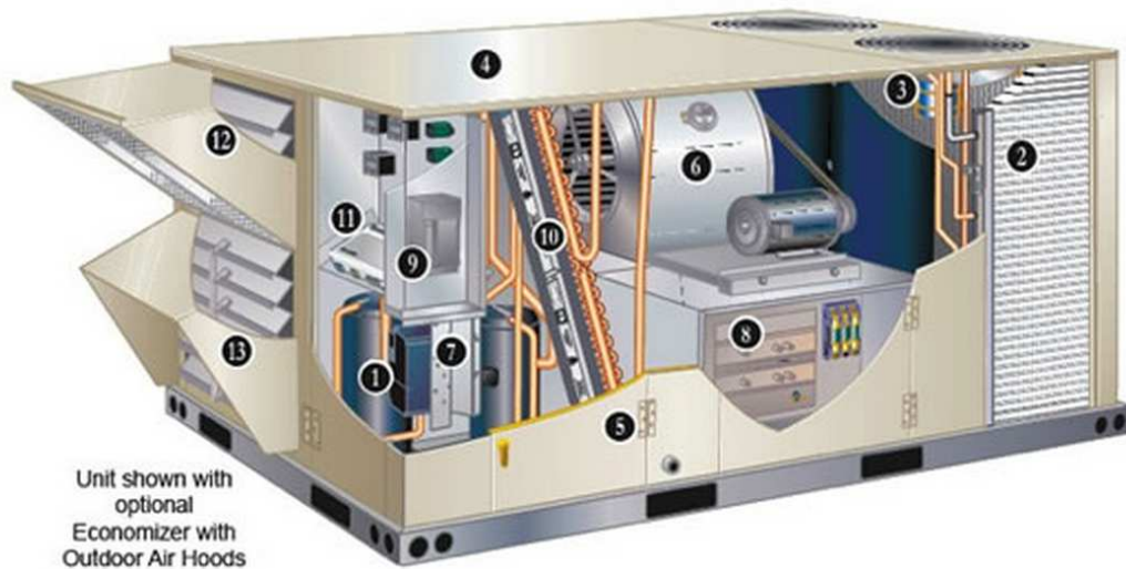
Obr. 10: 3D nákres rooftopové jednotky
