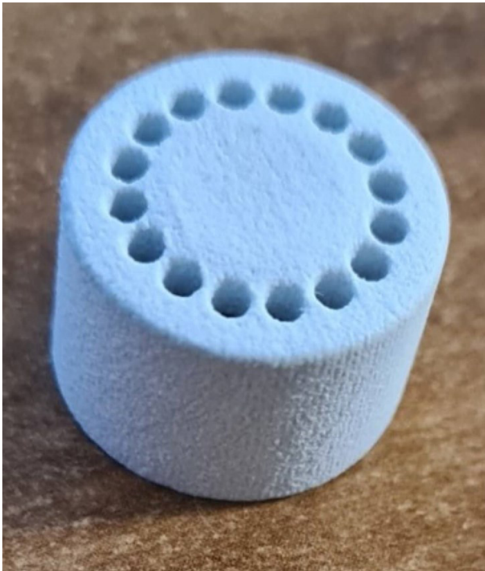
Obr. 3.5 Plastová tryska vyrobena pomocí 3D tisku
