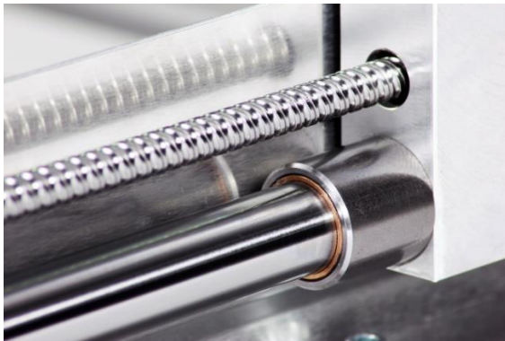
Obr. 2.11 Detail kuličkového šroubu a vodící tyče [10].
