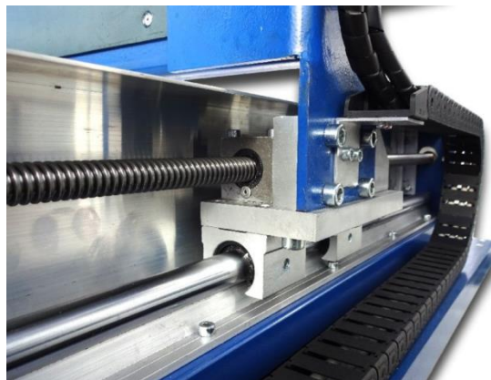
Obr. 2.18 Detail lineárního vedení a pohybového šroubu [12].
