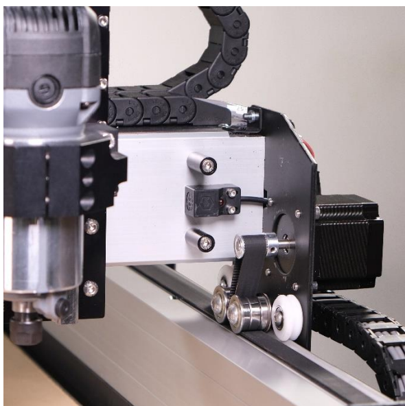
Obr. 2.5 Detail řemenu v ose X [5].
