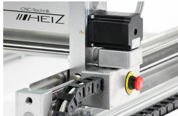
Obr. 2.12 Detail řešení umístění posuvu osy X a Y [10].
