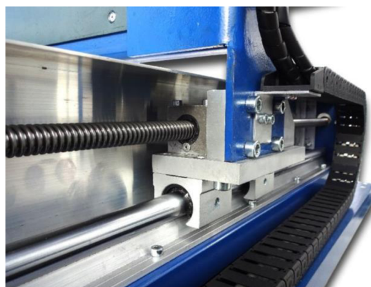
Obr. 2.18 Detail lineárního vedení a pohybového šroubu [12].
