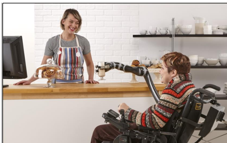
Obr. 25 Robotická paže Roboty Gen 2, která se připevňuje na invalidní vozík
