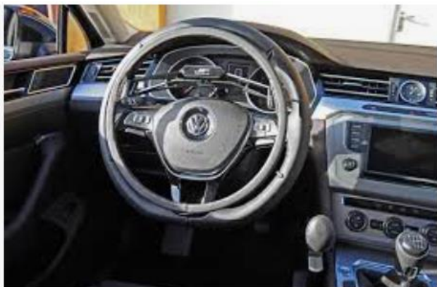
Obr. 29 Volat s kruhovým ovládním plynu na volantu
