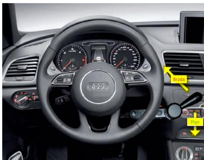
Obr. 34 Páčkové ovládání brzdy a plynu. Zdroj: Canocarhandy, 2022
