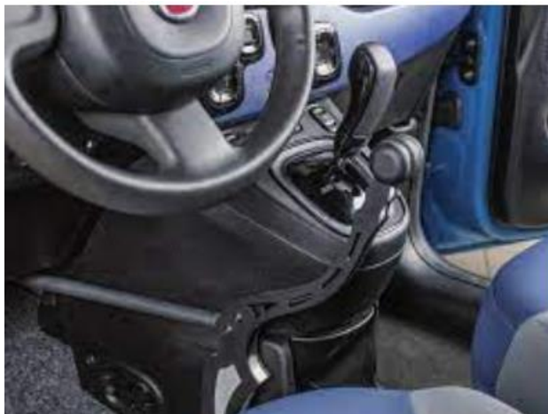
Obr. 33 Ovládání plynu a brzdy jednou pákou. Zdroj: Canocarhandy, 2022
