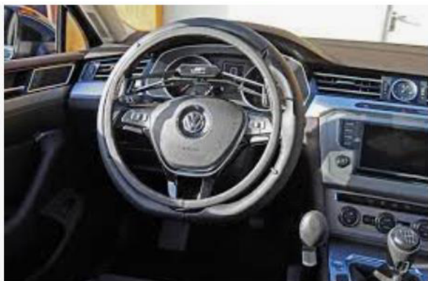
Obr. 29 Volat s kruhovým ovládním plynu na volantu
