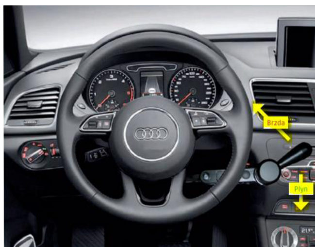
Obr. 34 Páčkové ovládání brzdy a plynu. Zdroj: Canocarhandy, 2022
