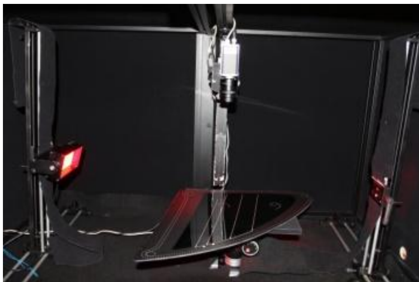
Obr. 11 Kamera, osvětlení a snímaný objekt v temném boxu
