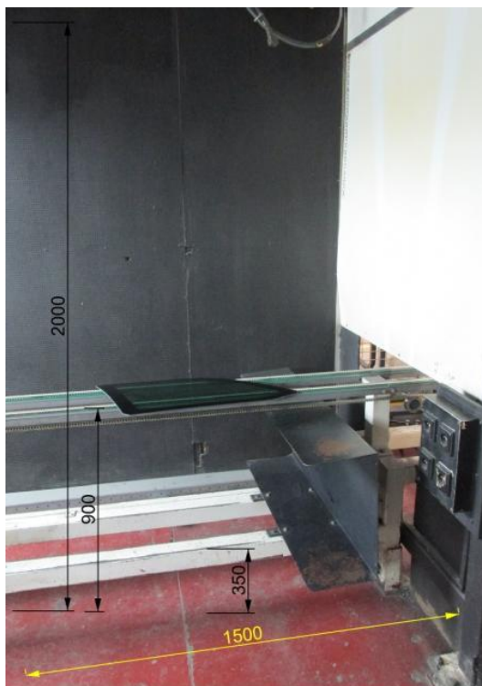
Obr. 20 Prostorové možnosti na zařízení v osách X a Z
