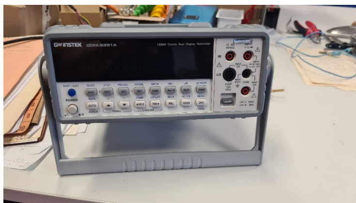
Obr. 5 Multimetr použitý pro statické měření (zdroj: autor)
