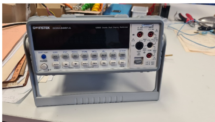
Obr. 5 Multimetr použitý pro statické měření (zdroj: autor)
