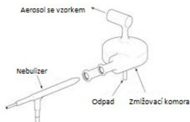
Obr. 2.4 Schéma Nebulizeru a Zmlžovací komory
