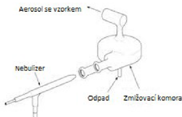
Obr. 2.4 Schéma Nebulizeru a Zmlžovací komory
