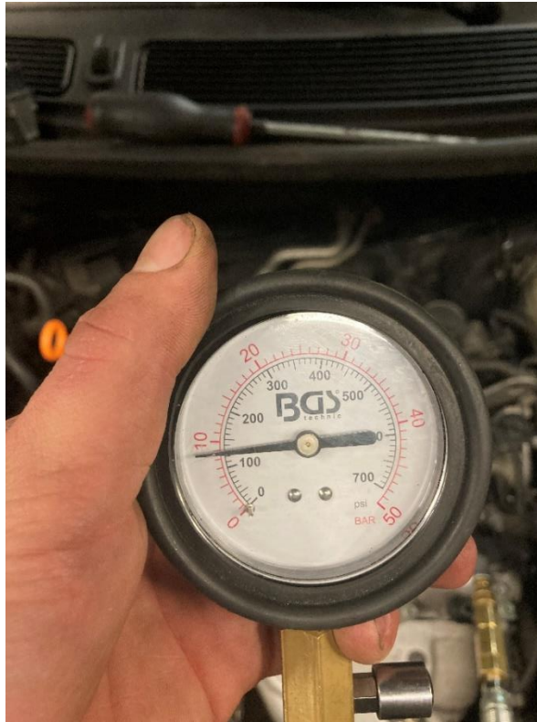
Obrázek 4.6: Měření kompresního tlaku
