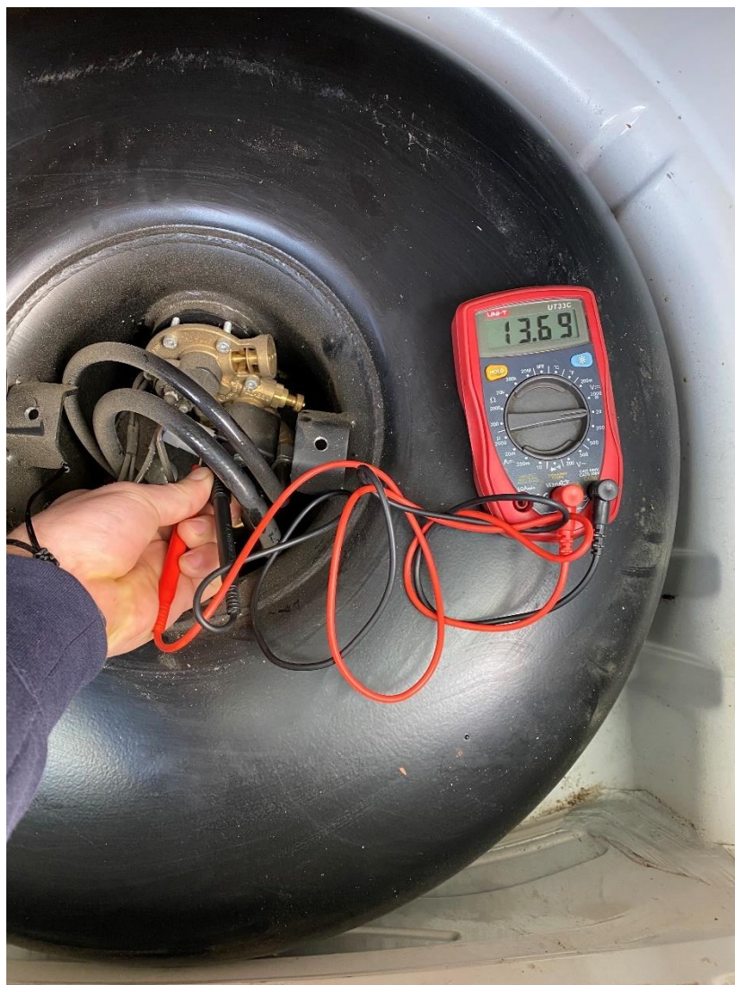
Obrázek 4.10: Měření napájecího napětí solenoidového ventilu multiventilu
