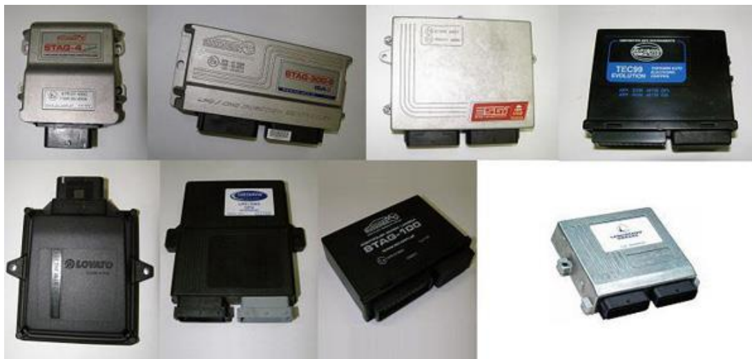
Obrázek 1.11: Řídicí jednotky systému LPG (Autanaplyn.com, 2020)
