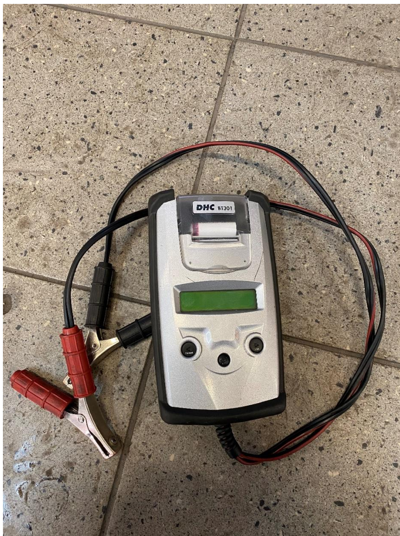
Obrázek 3.5: Tester akumulátorů GYS BT 501 DHC
