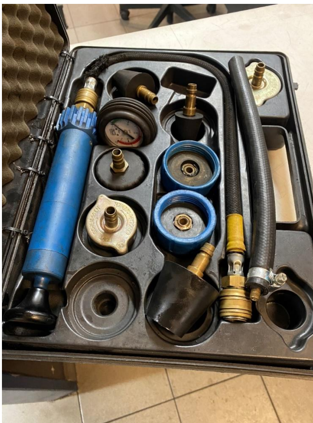
Obrázek 3.6: Tester chladicího systému 4800/7 HAZET
