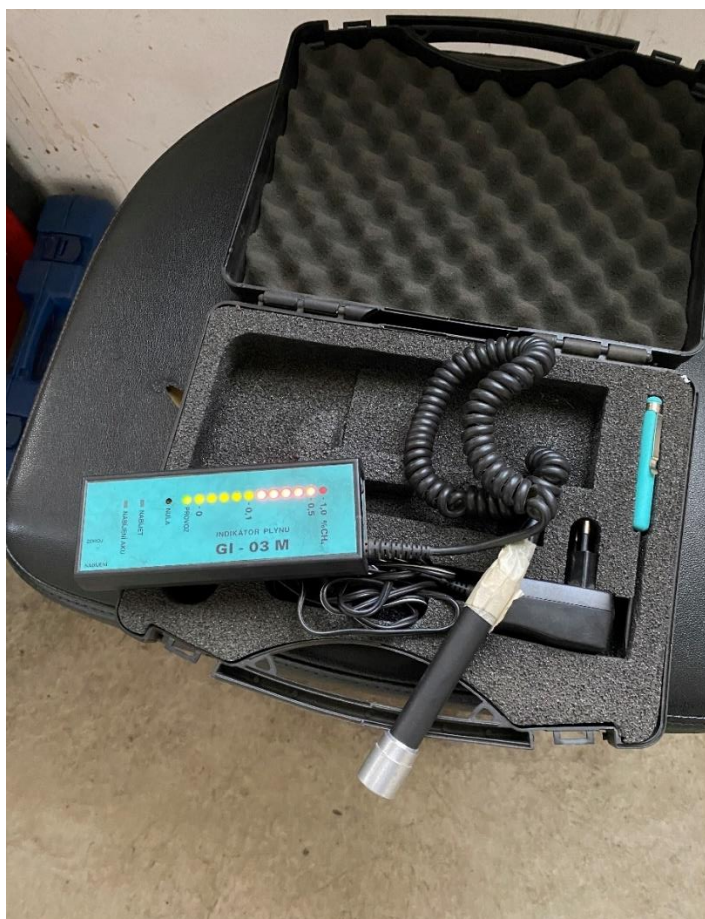
Obrázek 3.4: Indikátor hořlavých plynů a par GI-03M
