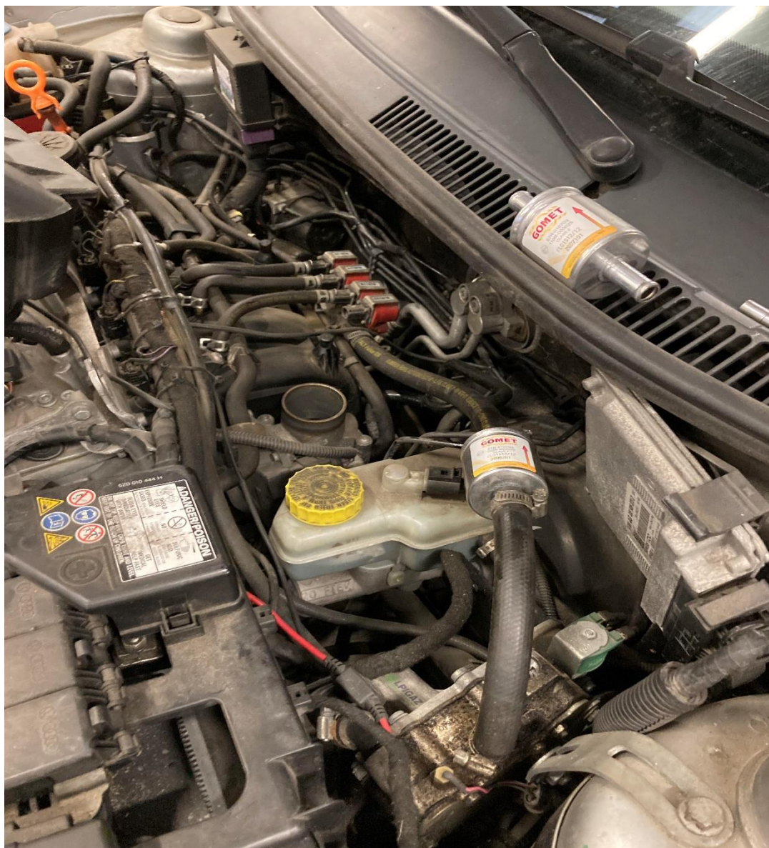
Obrázek 1.10: Výměna čističe plynné fáze
