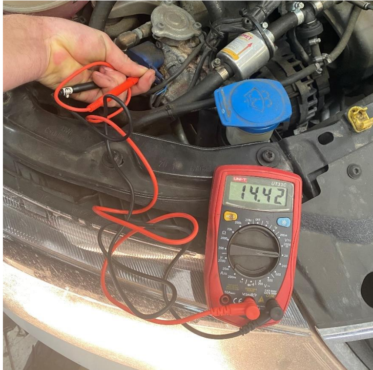
Obrázek 4.9: Měření napájecího napětí solenoidového ventilu
