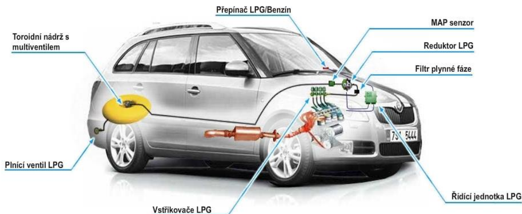
Obrázek 1.2: Schéma rozmístění komponent LPG ve vozidle (Autoservis-saku.cz, 2021)
