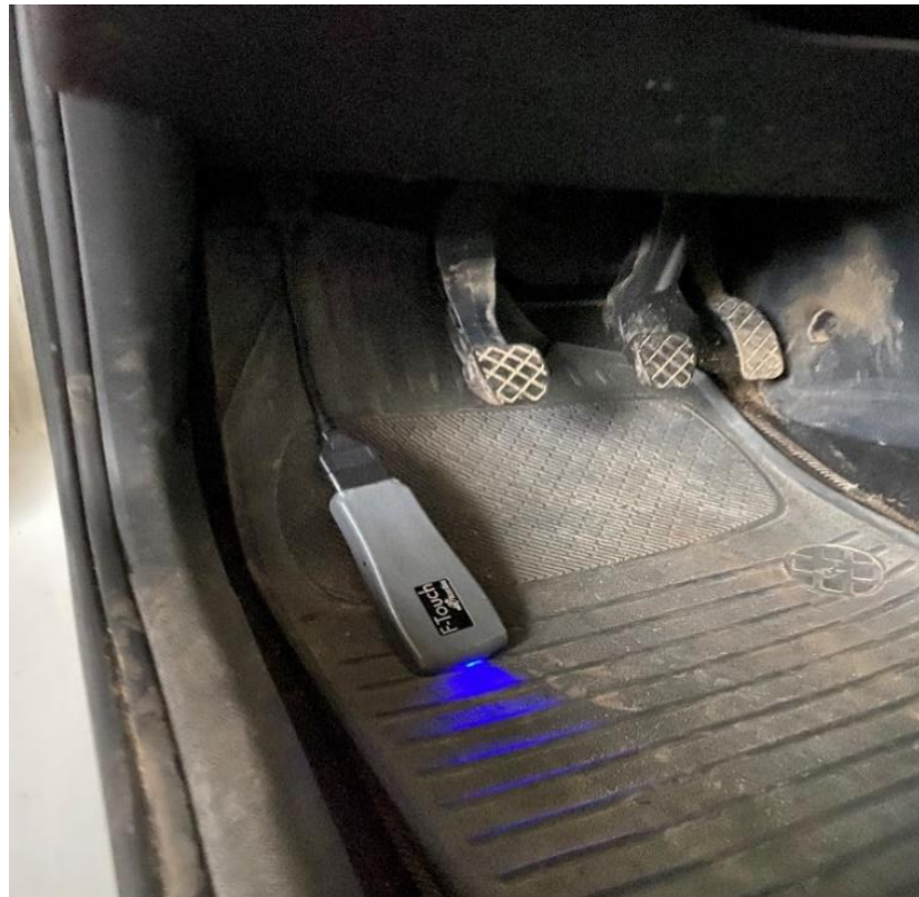
Obrázek 3.11: Komunikační modul emisního přístroje Brain Bee
