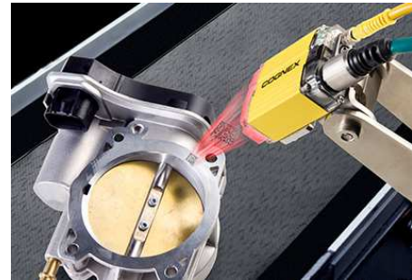
Obr. 3.23: Čtení 2D kódu na výrobku čtečkou Cognex [41]
