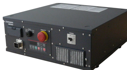
Obr. 3.14: Řídicí systém Mitsubishi CR750-D [29]
