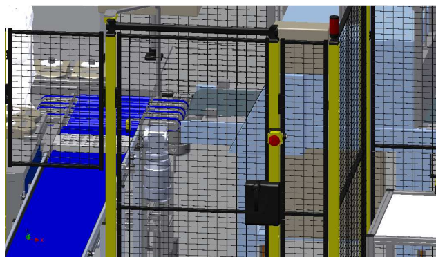
Obr. 8.4: Vstupní dveře RTP s bezpečnostním zámkem a tlačítkem „central stop“
