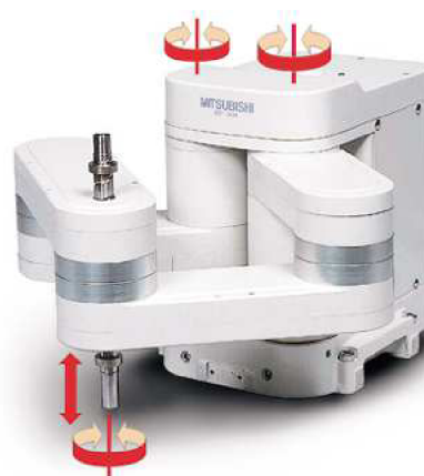
Obr. 3.8: Speciální konstrukce robotu SCARA Mitsubishi Electric řada RP [29]
