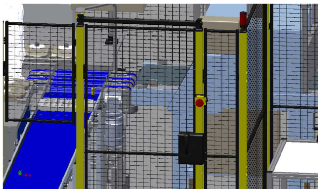
Obr. 8.4: Vstupní dveře RTP s bezpečnostním zámkem a tlačítkem „central stop“
