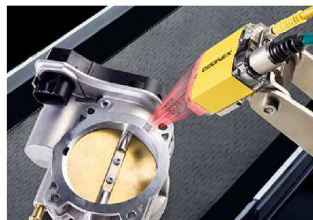
Obr. 3.23: Čtení 2D kódu na výrobku čtečkou Cognex [41]
