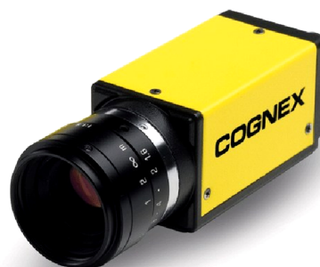
Obr. 3.26: „Inteligentní“ kamera Cognex In-Sight Micro [39]
