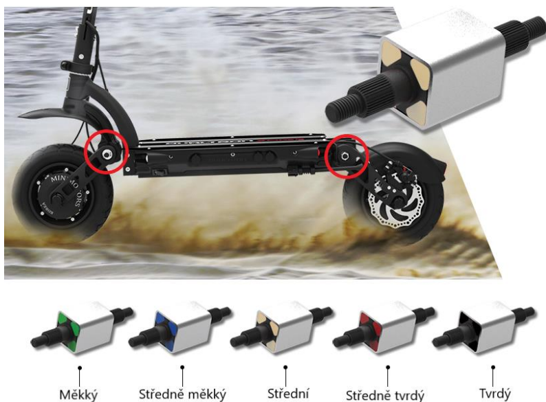
Obr. č. 9: Odpružení s elastomerem [25]
