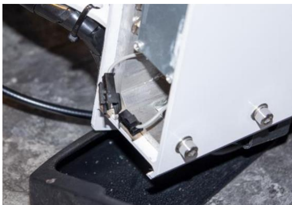
Obr. č. 20: Deaktivace omezovače rychlosti rozpojením drátků [53]
