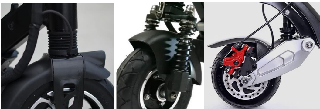
Obr. č. 7: Typy odpružení [22], [23], [24]
