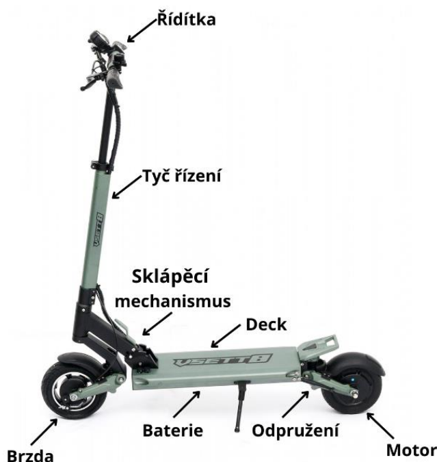
Obr. č. 2: Konstrukční prvky elektrokoloběžky [86]
