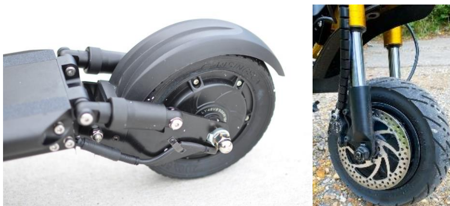
Obr. č. 8: Hydraulické odpružení [17], [24]
