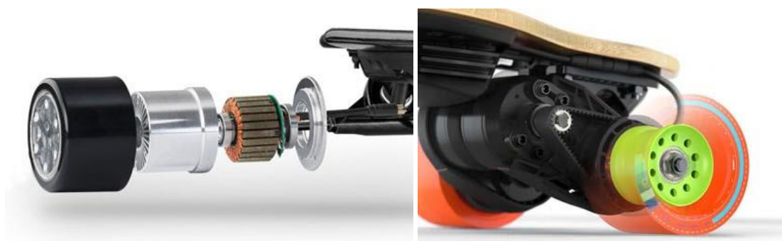
Obr. č. 16: Vlevo elektromotor umístěný v kole, vpravo pohon pomocí řemenu [28]
