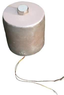
Obr. G.1: Jedna cívka houslového snímače (průměr 15 mm, výška 20 mm)
