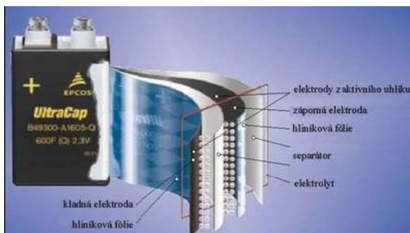
Obr. 1: Struktura superkondenzátoru [4]
