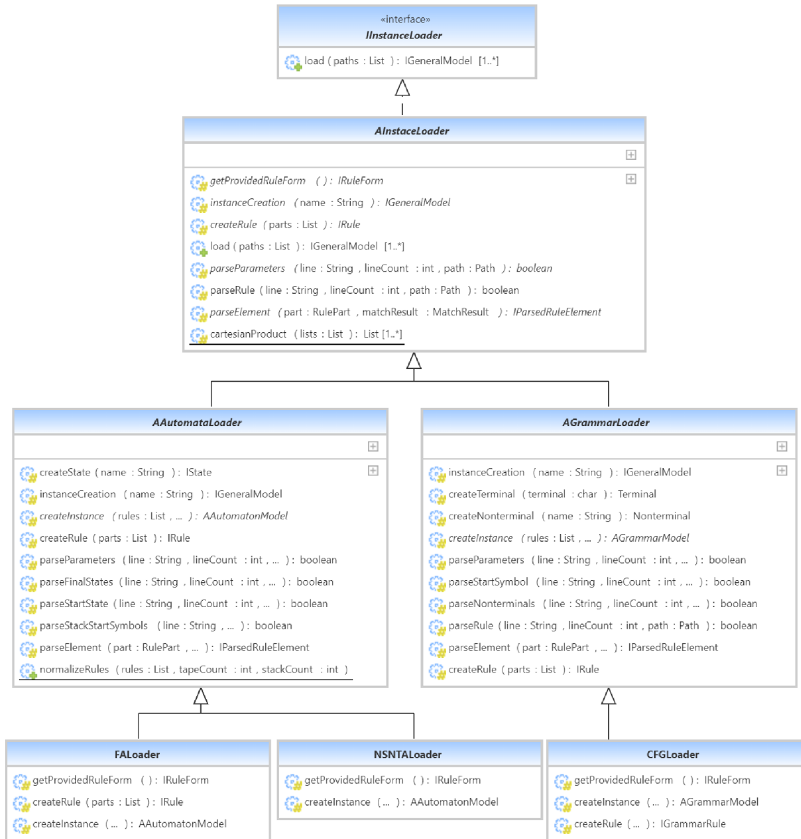
Obrázek 4.4: Diagram tříd - typová hierarchie načítačů instancí. Načítače FALoader , NSNTALoader a CFGLoader zde slouží jako příklady konkrétních načítačů. Diagram obsahuje pouze nejdůležitější metody. Některé hlavičky metod byly zkráceny.
