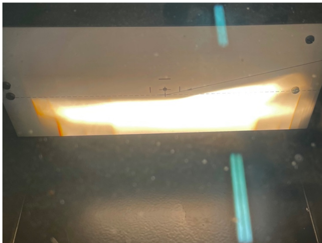
Obrázek 8 - Rozptyl světlometu v regloskopu (Zdroj: Vlastní)
