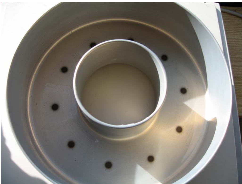
Obr. 9.2.3 – Znečištěný impakční talíř ( PM_{10} )
