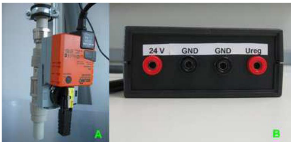
Obr. 8-2: Regulační ventil BELIMO a krabička napájení [BMF17]
