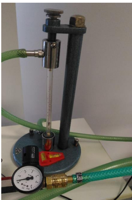
Obr. 8-3: Plováчковý průtokoměr s redukčním ventilem
