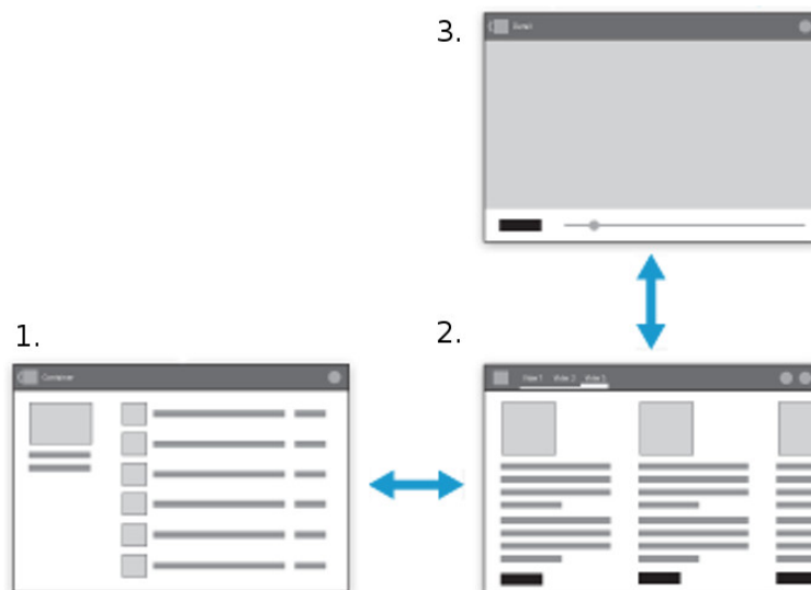
Obrázek 5.1: Návrh průchodu aplikací. 1. hlavní aplikační obrazovka zobrazující seznam pořízených snímků, odkud se bude provádět manipulace s daty (jako jejich pořizování a odesílání). 2. obrazovka detailu položky fotografie umožňující uživateli manipulovat s jednotlivými graffiti záznamy a anotovat tato data. 3. editor pro výběr oblasti graffiti ve fotografii.
