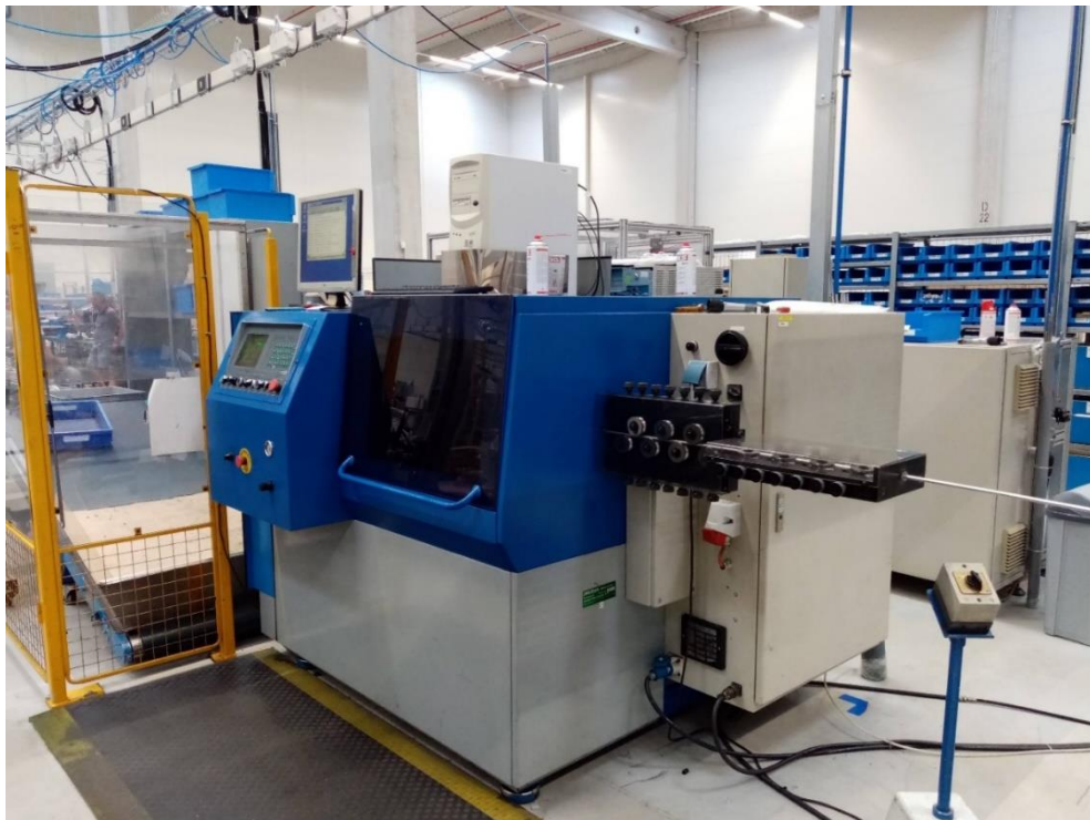
Obrázek 9: Sekce rovnání trubek (Zdroj: Vlastní zpracování, 2021)
