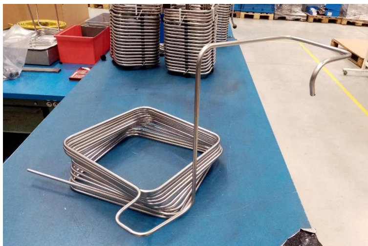
Obrázek 7: Koš po procesu ohýbání (Zdroj: Vlastní zpracování, 2021)
