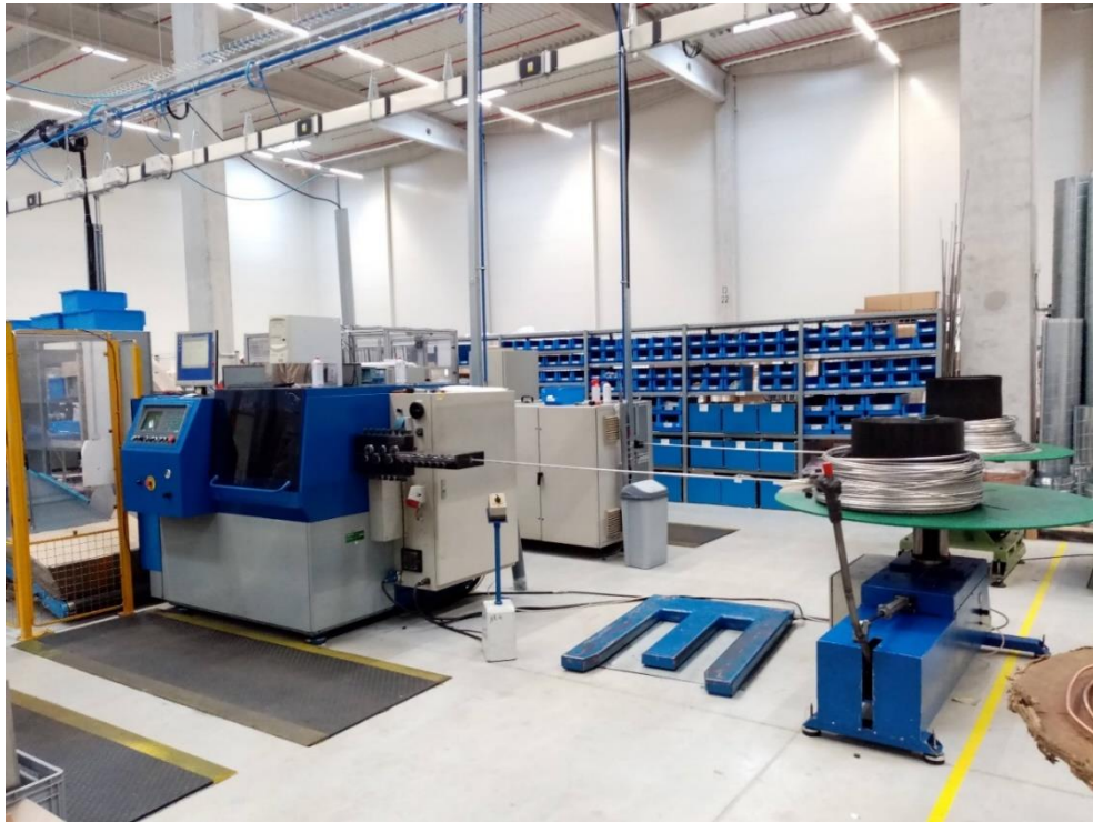
Obrázek 8: Vstup materiálu do ohýbačky (Zdroj: Vlastní zpracování, 2021)
