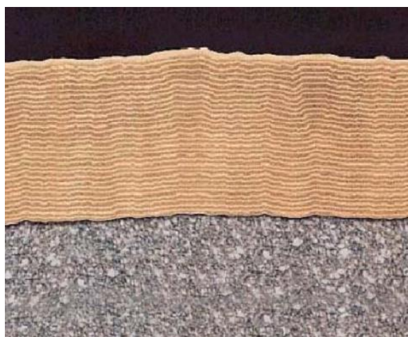
Obr. 8 - Multivrstvý systém skládající se z 62 střídajících se vrstev TiN/TiC [21]
