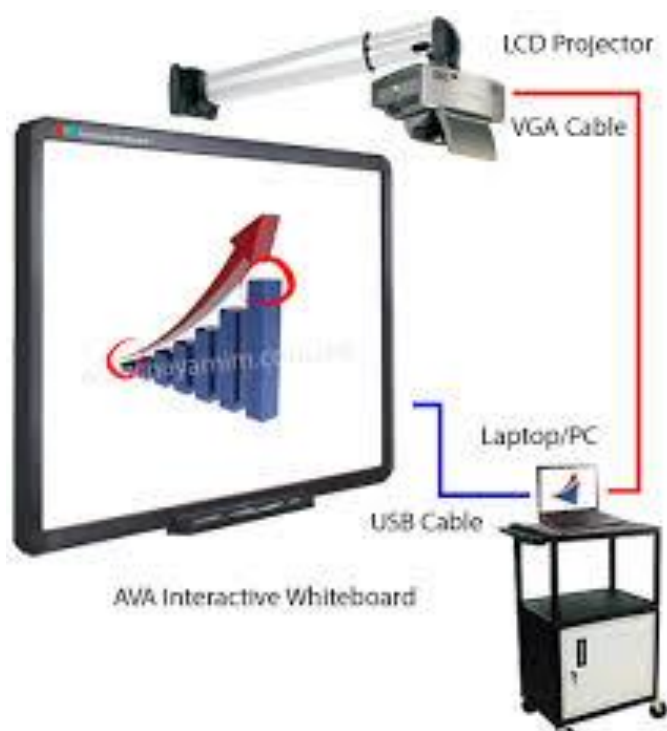
Obrázek č. 1: Schéma základních prvků interaktivní tabule
