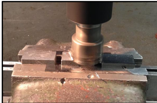
Obr. 48 – Frézování třech vzorků typu B s termočlánky typu K
