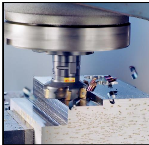
Obr. 1 – Proces čelního frézování [12]
