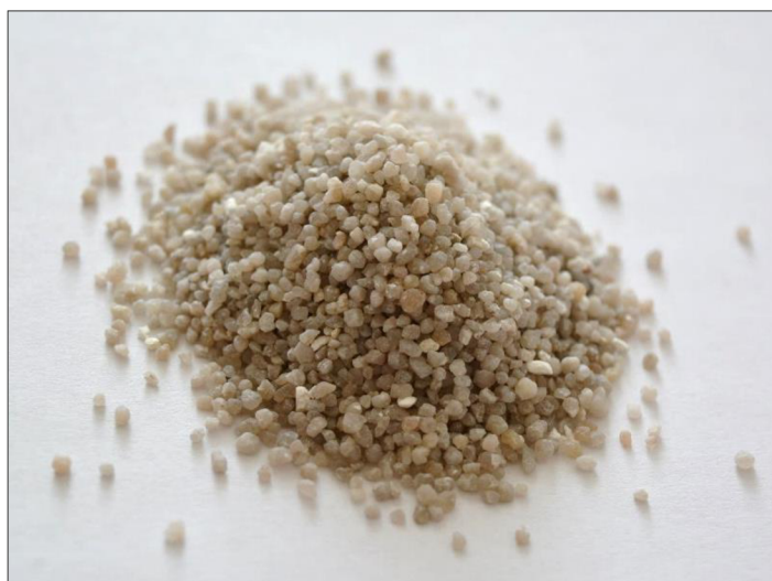
Obr. 3.1 Filtrační materiál Dorsilit [autor]
