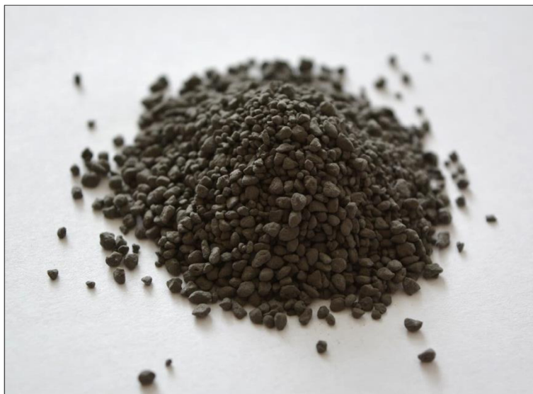
Obr. 3.9 Filtrační materiál Birm [autor]
