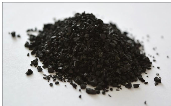
Obr. 3.4 Aktivní uhlí Filtrasorb F100 [autor]
