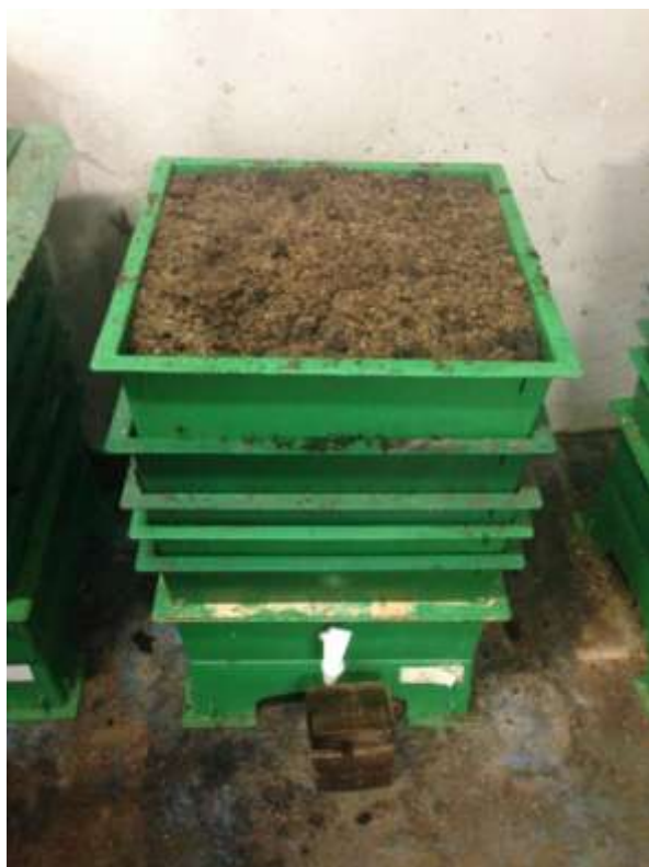
Obr. č. 2: Vermikompostér č. 3 s 50 % kávové sedliny a 50 % slaměných pelet (foto vlastní)
